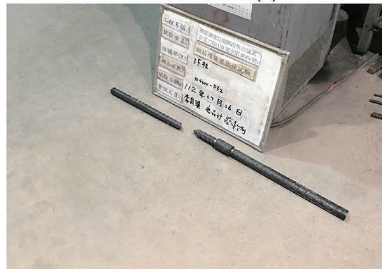
鋼筋拉伸試驗 (2)
