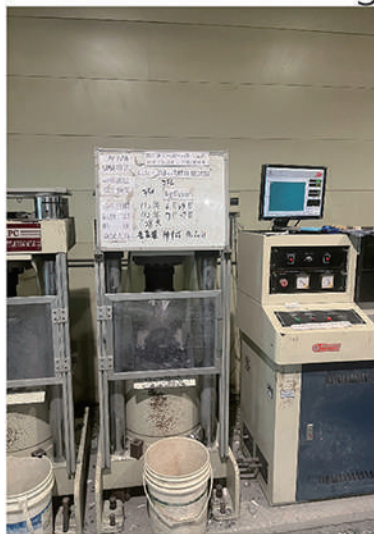
2FL水泥柱體壓力測試 350kgf_試驗中
