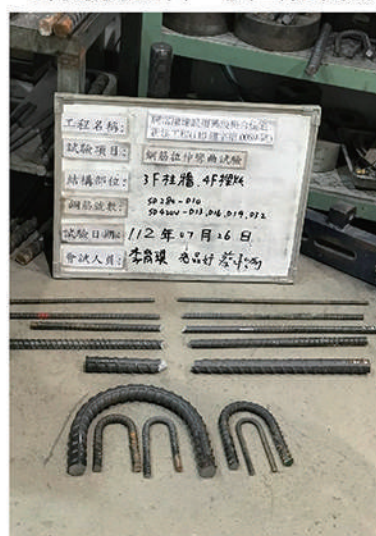
鋼筋拉伸彎曲試驗
