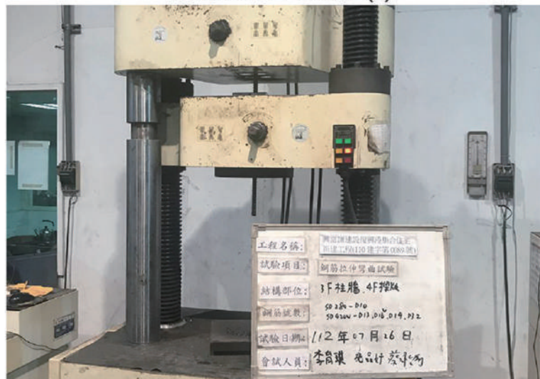
鋼筋拉伸試驗 (1)
