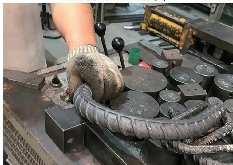
鋼筋彎曲試驗 (2)
