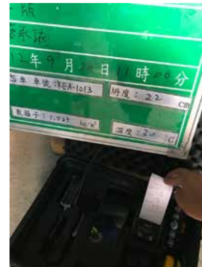
混凝土氯離子檢測
