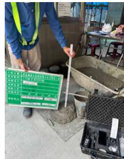
混凝土氯離子檢測
