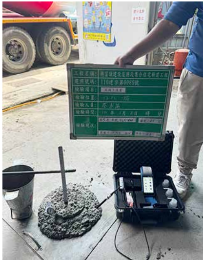
混凝土氯離子檢測
