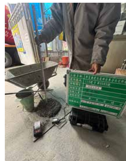
混凝土氯離子檢測
