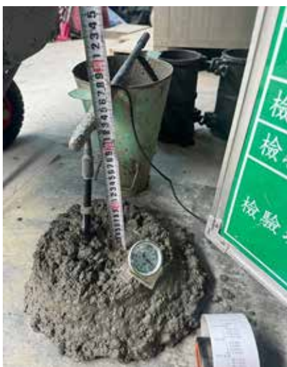
混凝土坍度檢測
